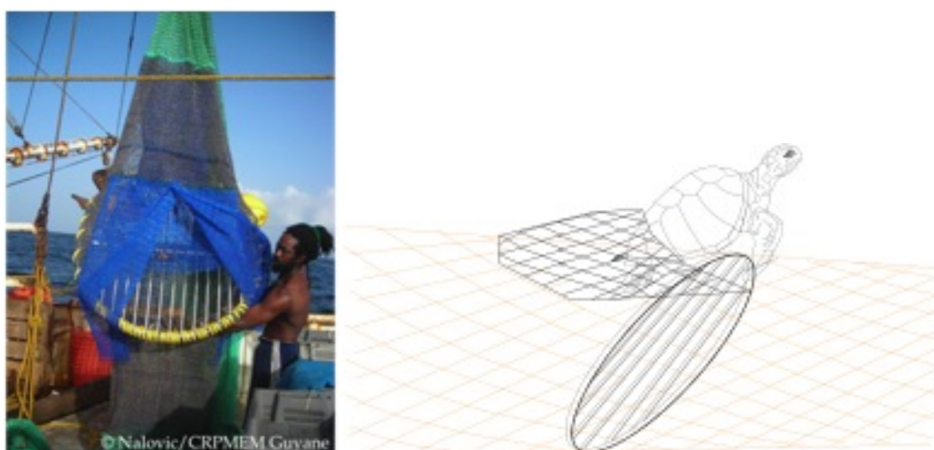
Figure 17 : TTED à barreaux plats testé et adopté en Guyane française et schéma explicatif (d'après Sacchi 2008).
